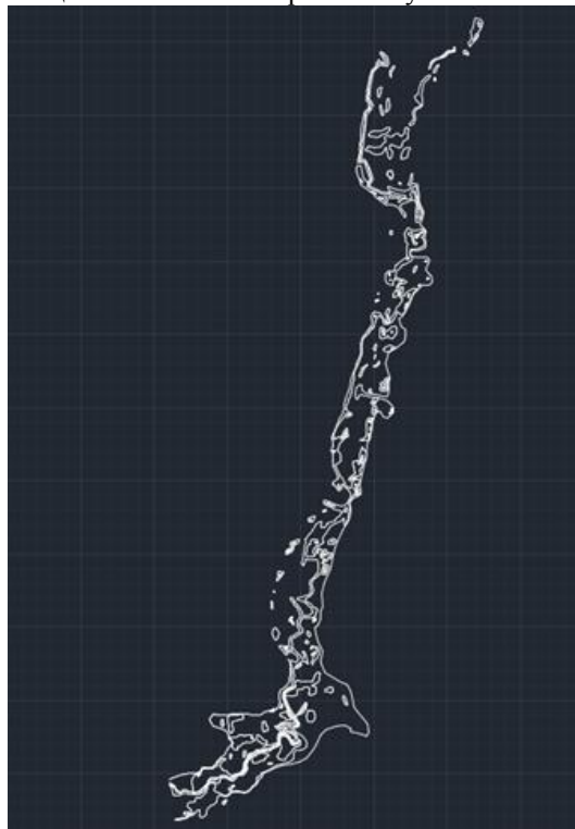
Рис. 4 – Результат оцифровки топографической карты дна водохранилища
